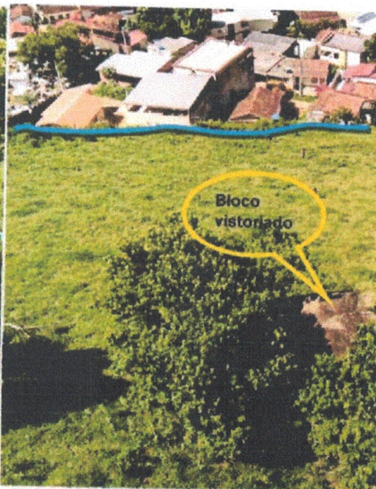
FOTO 02 (DRONE) – Linha azul claro mostra imóveis residenciais próximas à base da encosta e na linha de influência de um eventual impacto do bloco (polígono amarelo) em caso de deslizamento.
